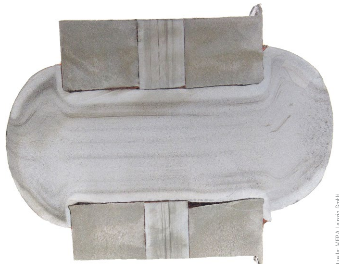
Bild 8 Nietverbindung mit ausgeprägten Seigerungslinien Rivet joint with pronounced segregation lines
